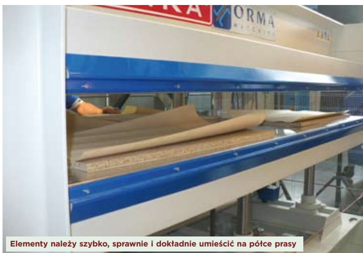
Układanie forniru na pokryte klejem elementy
