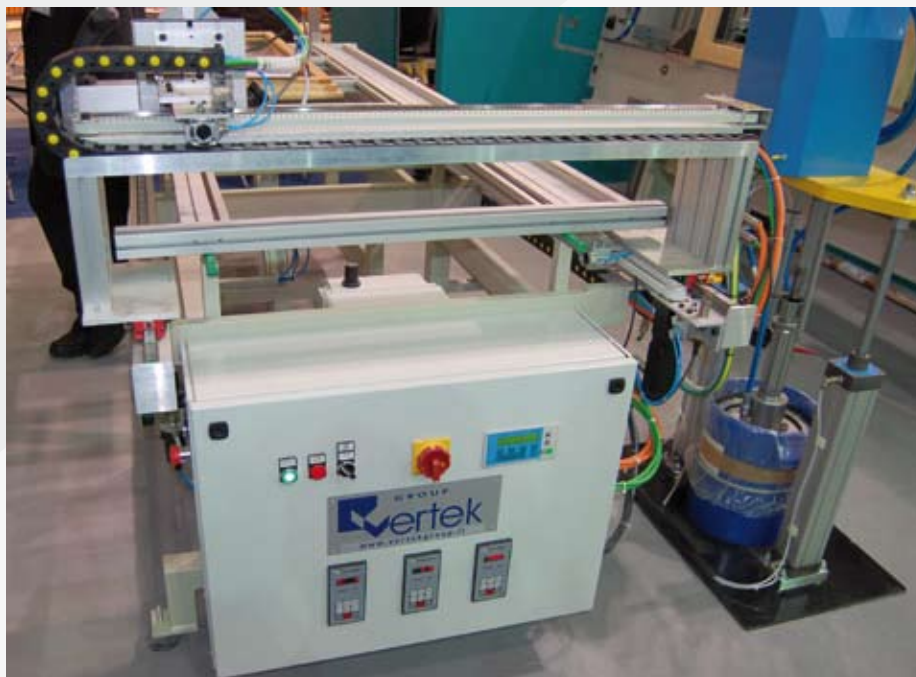
Doskonała maszyna do silikonowania różnych typów okien.
