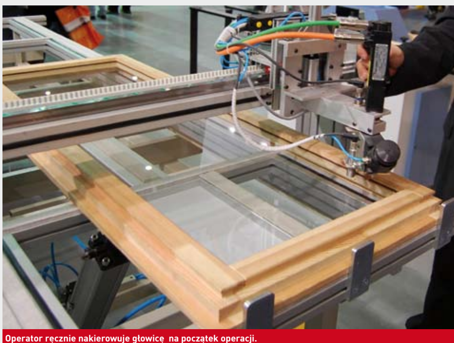
Operator ręcznie nakierowuje głowicę na początek operacji.
