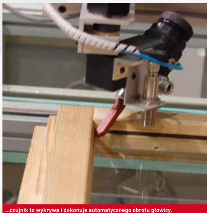
...czujnik to wykrywa i dokonuje automatycznego obrotu głowicy.
