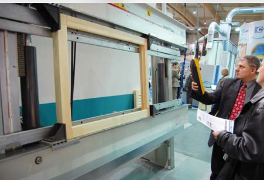
Cykle robocze są sterowane z PLC.
